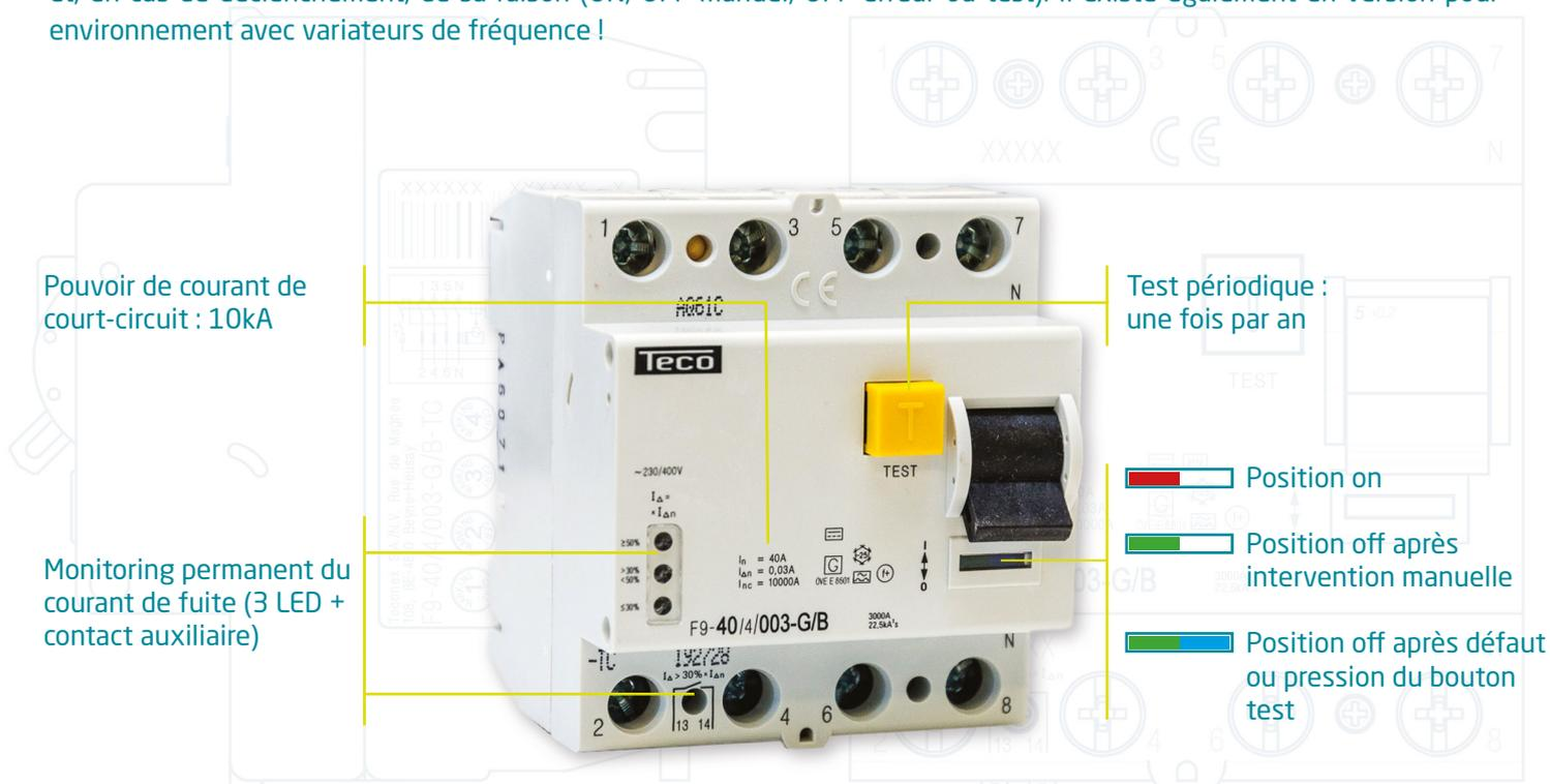
**Interrupteur différentiel F9, 4 pôles, type B**
